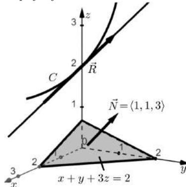
Donde  $\vec{R}$  es el vector tangente a  $C$  y  $\vec{N}$  la normal al plano, luego se procede a parametrizar la curva de la siguiente manera:
