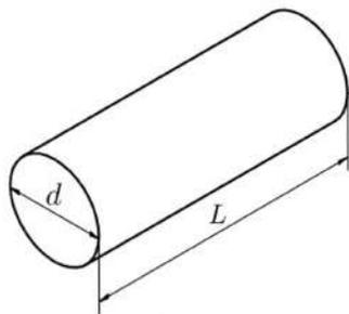
$$\begin{array}{ll} V(d, L) = \pi \left(\frac{d}{2}\right)^2 L & \text{función objetivo a maximizar} \quad (d > 0, L > 0) \\ 108 = L + \pi d & \text{restricción} \end{array}$$
